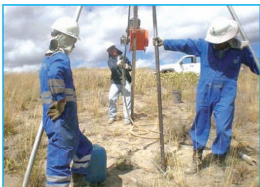
[Fig. 5].- Ensayo SPT discontinuo en Ecuador.
