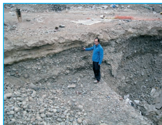
[Fig. 8].- Gravas del río Rímac, en la zona de Surco (Lima). Nótese la presencia de niveles arenosos y limosos donde si es factible la realización de un ensayo SPT (y no en la parte en gravas). En algunas zonas de Lima metropolitana el espesor del paquete de gravas con cambios de facies limo-arenosas, puede llegar a los 400 m.
