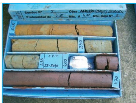
[Fig. 6 bis].- Caja de sondeos donde se muestra la toma de muestra y ensayo SPT.
