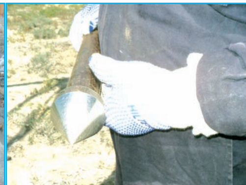
[Figura 10].- Detalle de la punta perdida del Cono .
